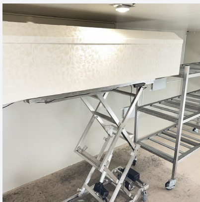
遺体用冷蔵庫 安置台 3 段目
